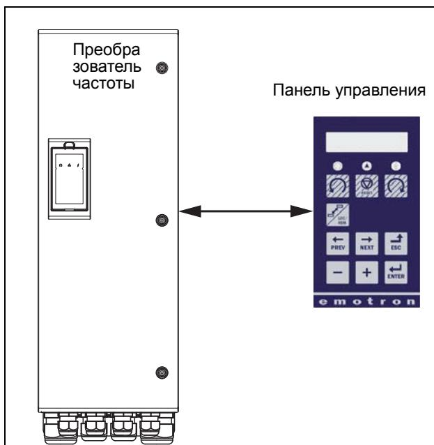
Рис. 43 Копирование и загрузка параметров между преобразователем частоты и панелью управления
