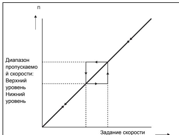
Рис. 82 Пропускаемая скорость
