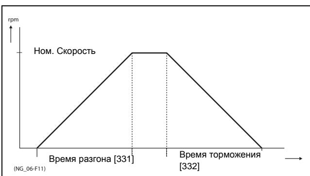
Рис. 76 Время разгона и торможения
