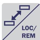
Эта кнопка выполняет две функции: Быстрый переход и местное/внешнее управление ПЧ(Loc/Rem) Для использования функции быстрого перехода нажмите и удерживайте кнопку в течение одной секунды.
