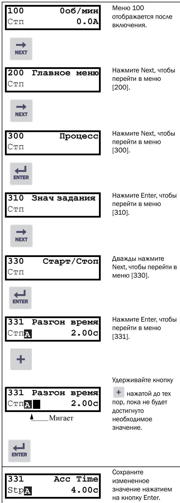
Рис. 67 Пример программирования
